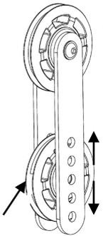
Régler la tension du système de câbles en déplaçant la poulie inférieure située dans la bride de poulie flottante double.
