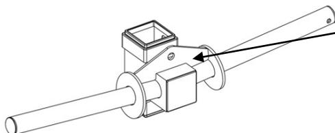
**Veiller à ce que le raccord triangulaire du câble situé sur le support des plaques de poids coulissant soit orienté vers le haut et vers l'arrière.**
