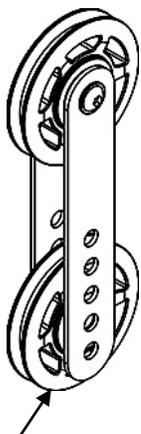
Régler la tension du système de câbles en déplaçant la poulie inférieure située dans la bride de poulie flottante double.
